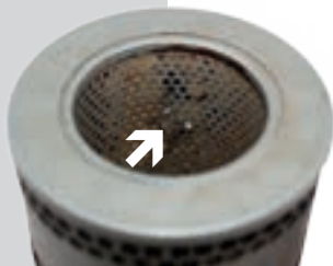
Durch Reinigung zerstörtes Filtergewebe Destroyed filter material caused by cleaning
